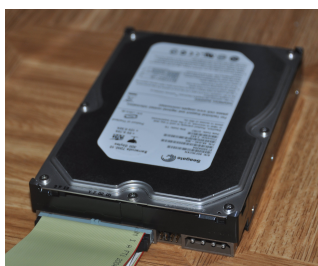
Festplatte an PATA-Datenkabel
